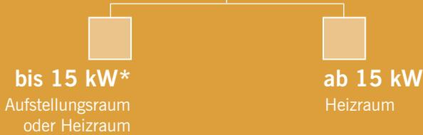
Automatisch beschickte Feuerungsanlagen bis zu 15 kW können unter bestimmten Voraussetzungen auch außerhalb von Heizräumen in Aufstellungsräumen betrieben werden.
