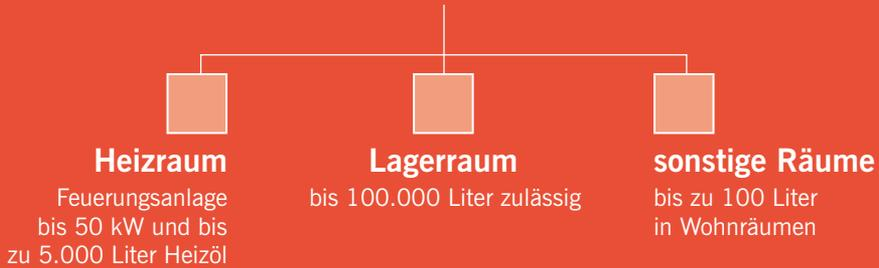
Bei Feuerungsanlagen unter 50 kW dürfen bis zu 5.000 Liter Heizöl im Heizraum gelagert werden.
